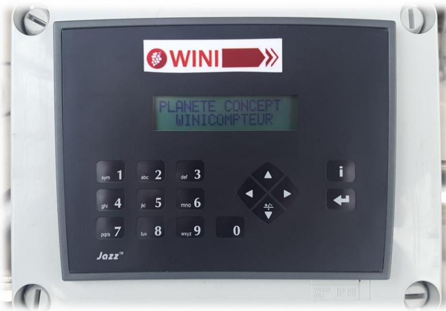
Fixé sur le chariot du WINIcompteur, ce boîtier permet un paramétrage plus simple.
